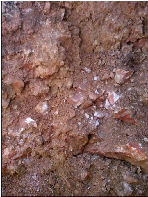
Fotografía.1. Detalle de cuerpo tabular de litología cuarcítica que corta a las pizarras PC en el punto de reconocimiento C-3.
