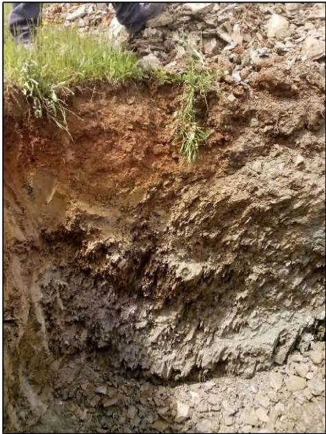
Fotografía.3. Detalle de la serie Pizarrosa-grauvácica (PC) con planos de esquistosidad verticalizados de bajo espaciado.
