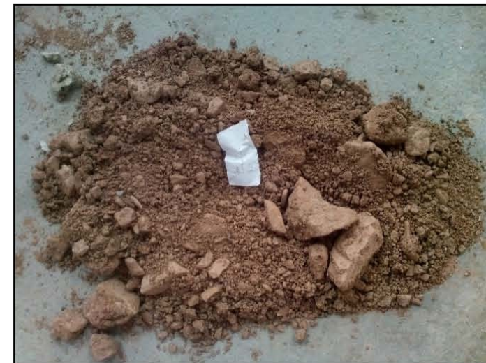
Fotografía. 12. Detalle de material cuaternario encontrado en la prospección C-2. Grava arenosa o arena con cantos de grauvaca y pizarra.
